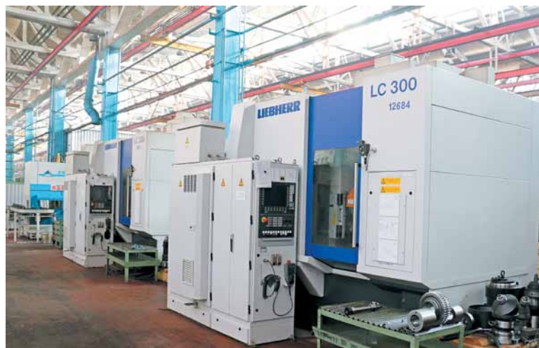
Высококачественная обработка внутренних и наружных зубьев шестерен зубофрезерованием и зубошлифованием на современных станках с числовым программным управлением
